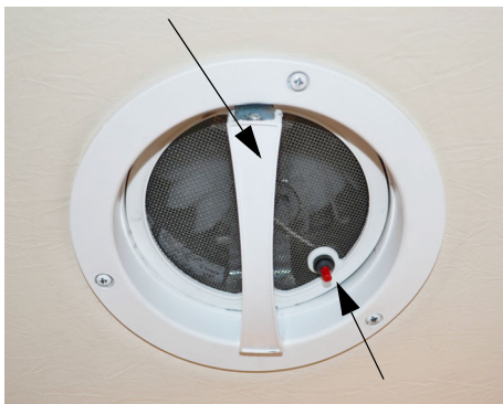
Fan Power Switch
