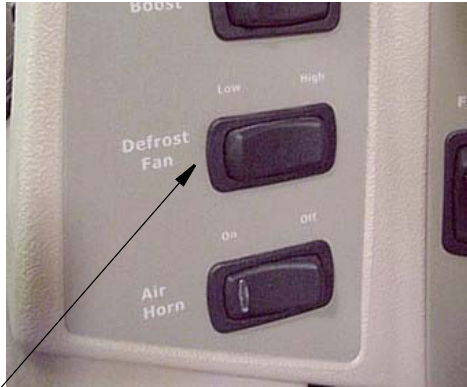
Defrost Fan Switch
